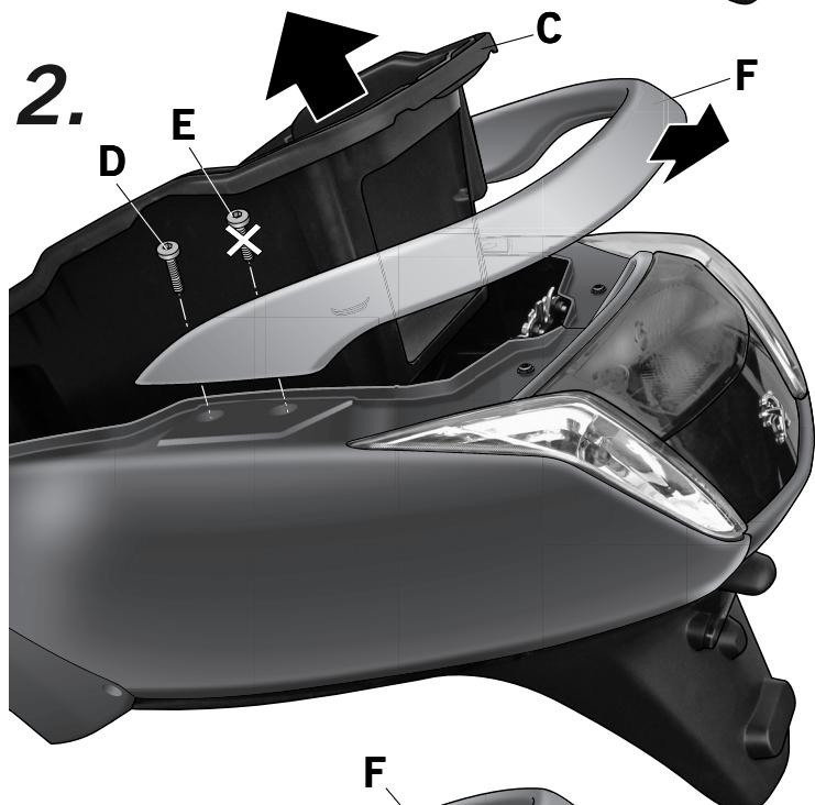
(E) Levantar éste alojamiento para acceder a los tornillos (D)(E) del agarradero (F). Desmontar el agarradero (F) y montar el soporte KIT TOP (1) mediante los distanciadores (2), las arandelas (3) y los tornillos (4).
